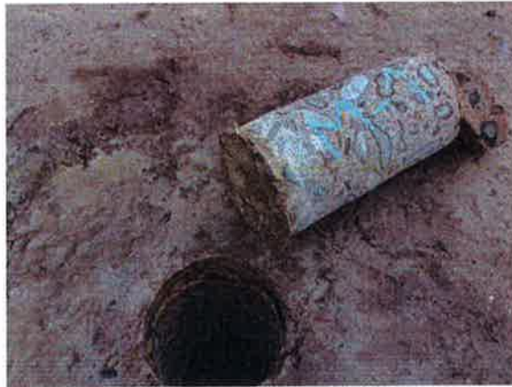
FIG. 8: EXTRACCIÓN DE MUESTRA DE DIAMANTINA EN LA LOSA DE TECHO
