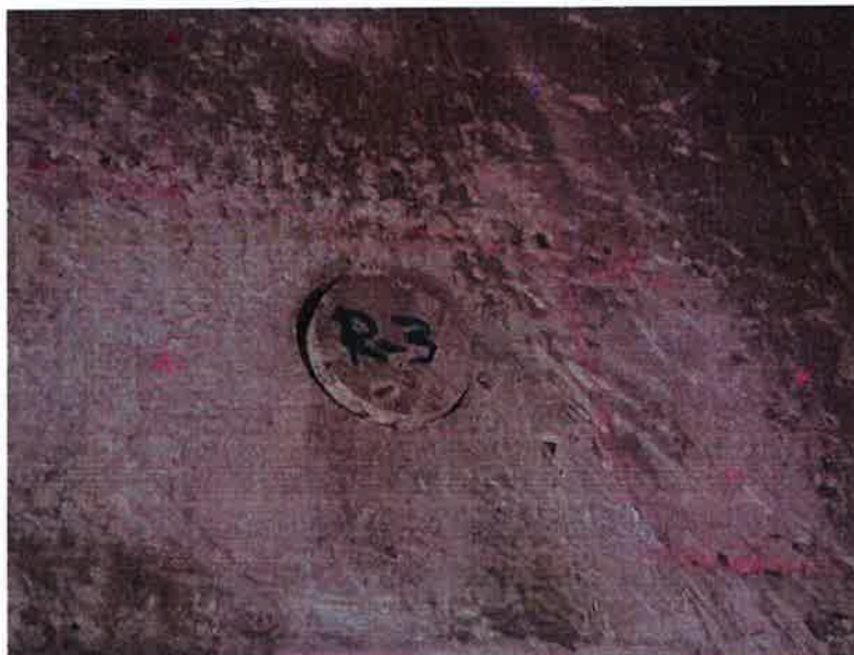
FIG. 20: EXTRACCIÓN DE MUESTRA DE DIAMANTINA EN LA PARTE INFERIOR DE LA CUBA
