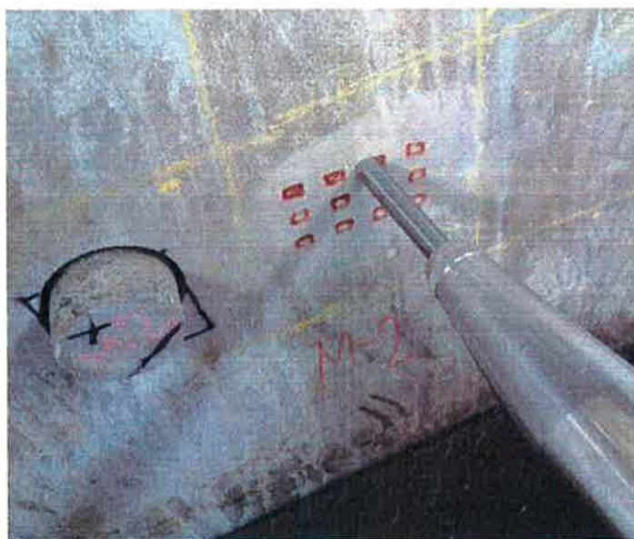
FIG. 5: UTILIZACIÓN DE ESCLEROMETRO PARA DETERMINAR LA DURABILIDAD DEL CONCRETO EN LA CUBA
