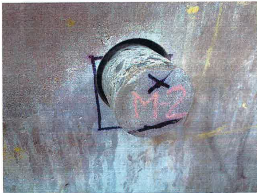
FIG. 9: EXTRACCIÓN DE MUESTRA DE DIAMANTINA EN PARTE SUPERIOR DE LA CUBA
