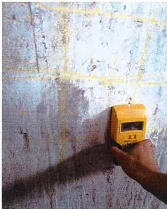
FIG. 12: DETECCIÓN DE ACERO DE REFUERZO EN LA CUBA DEL RESERVORIO
