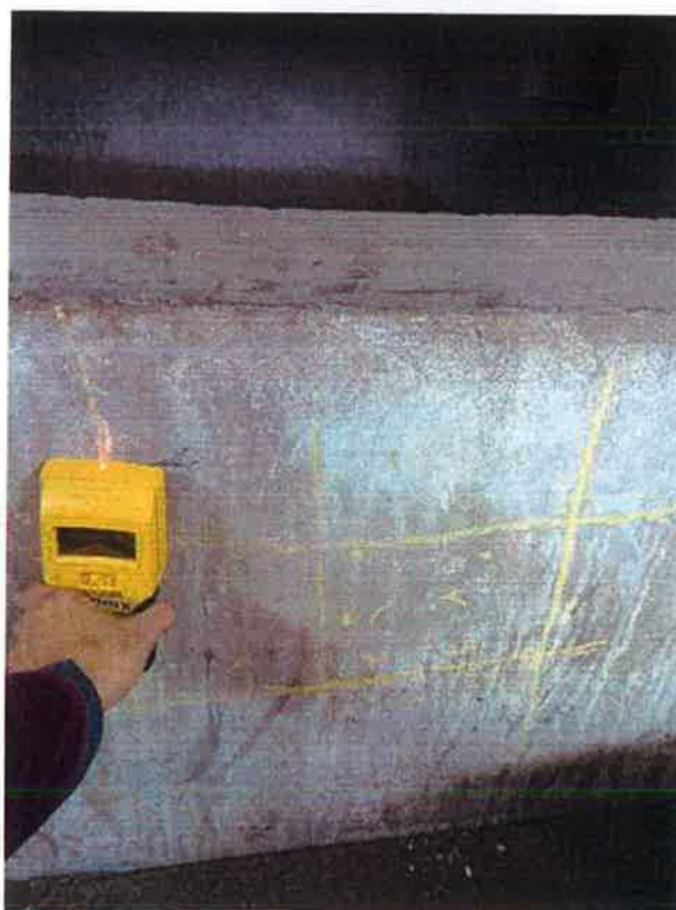
FIG. 3: DETECCIÓN DE ACERO DE REFUERZO EN LA CUBA DEL RESERVORIO
