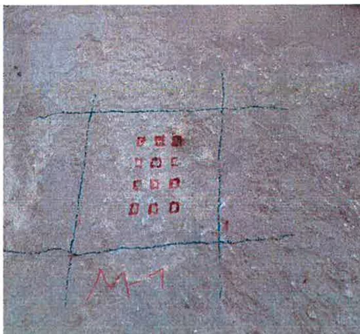
FIG. 4: TRAZO PARA DETERMINAR LA DURABILIDAD DEL CONCRETO EN LA LOSA DE TECHO UTILIZANDO ESCLEROMETRO
