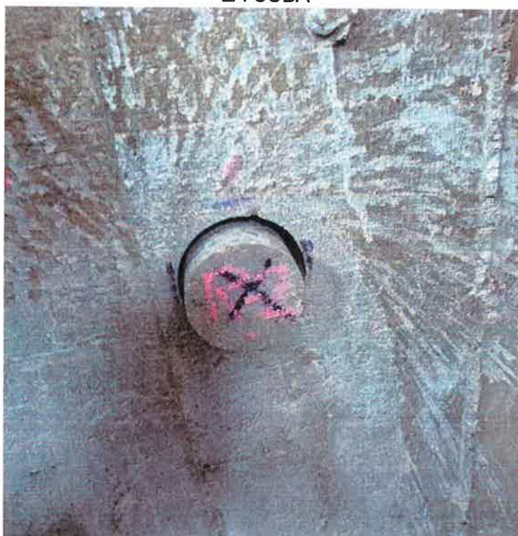
FIG. 19: EXTRACCIÓN DE MUESTRA DE DIAMANTINA EN LA PARTE SUPERIOR DE LA CUBA
